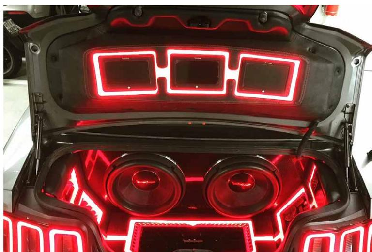
Blick in den Kofferraum des Ford Mustang: oben drei Bildschirme für Videoclips, in der Mitte zwei Subwoofer mit 5'000 Watt, darunter der Subwoofer-Verstärker. Links der digitale Signalprozessor, rechts die 600A-Absicherungen der Anlage. Gesamtleistung: beeindruckende 6'200 Watt
