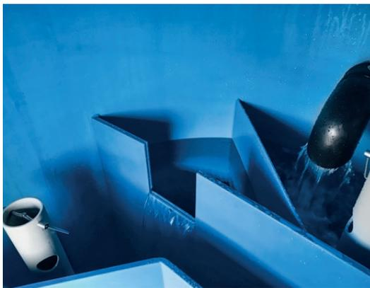
Pièces au contact de l'eau en polyéthylène (PE) ou acier inox (V2A / V4A)
