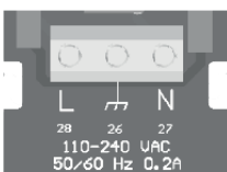
Anschlüsse Netzspeisung 110-230 VAC
