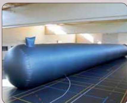
L'involucro interni per il risanamento di serbatoi a parete singola
