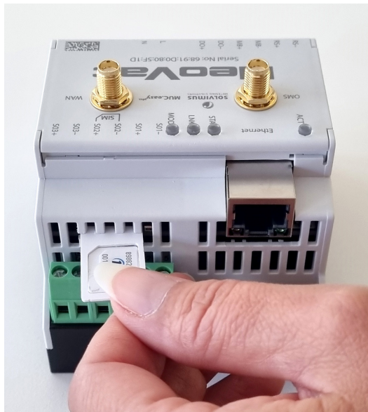
Figure 2 – Insertion de la carte SIM dans un appareil avec modem
